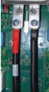
Abbildung 4-5: Beispielhafte Darstellung des Anschlusses der Leistungsleitungen Plus und Minus am Wechselrichter SMA Sunny Island
