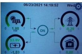
Der während des Tages erzeugte Strom wird zunächst für den Verbrauch zur Verfügung gestellt. Der nicht verbrauchte Sonnenstrom wird in die Batterie über BW-HY3600 / 4600 geladen.
