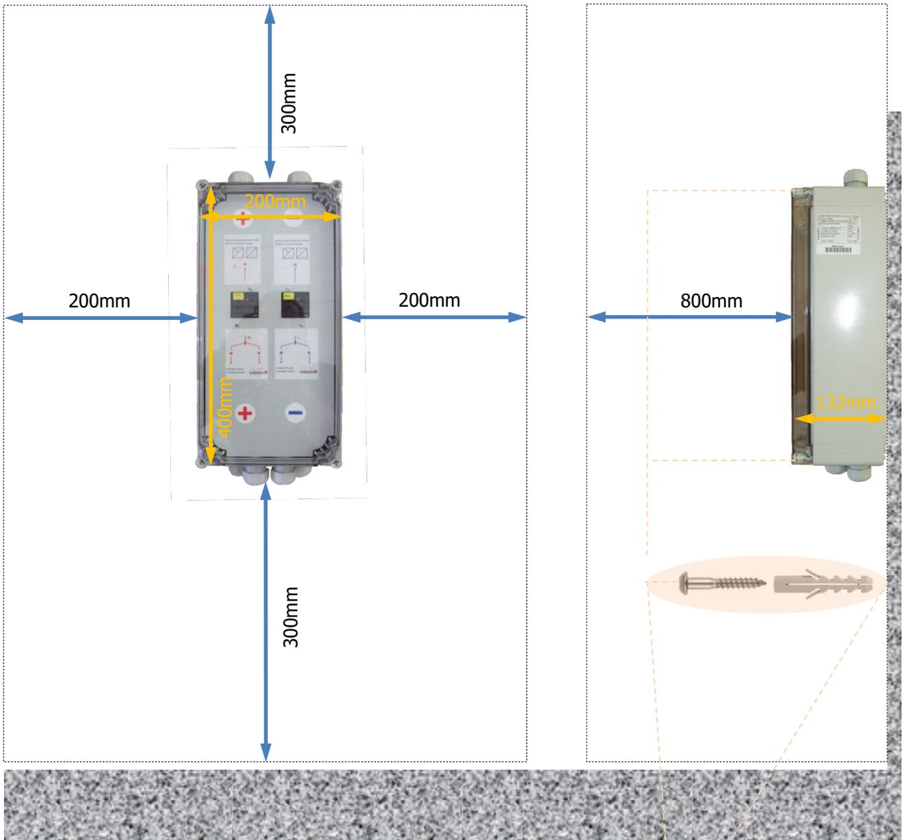
Wählen Sie **je nach Untergrund** eine passende Befestigungsart, **z.B.** mittels 4 x Spreizdübel S8 und 4 x Spanplatten/Holzschraube 5.0
