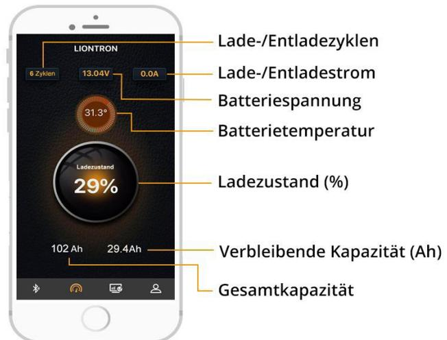
Für die Verbindung von Batterie und einem Smartphone / Tablet muss das Gerät die Bluetooth Version 4.0 unterstützen.
