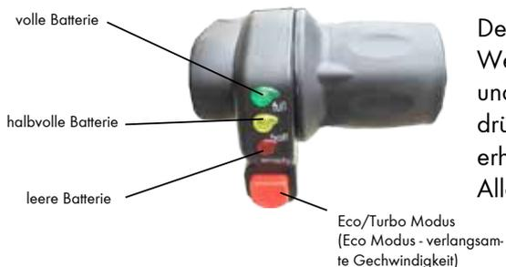
Der rote Knopf am Gashebel ist der Eco / Turbo Modus. Wenn diese Taste nicht gedrückt wird, befindet sich Ihr Scooter im Eco-Modus und der Stromverbrauch Ihres Scooters reduziert sich. Wenn die Taste gedrückt wird, befindet sich der Scooter im Turbo-Modus. In diesem Modus erhöht sich die Geschwindigkeit und Leistung Ihres Elektromobils erheblich. Allerdings erzielen Sie in diesem Modus eine geringere Reichweite.
